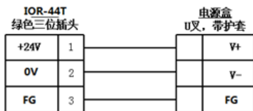
IOR-44T电源盒接线 多股线
